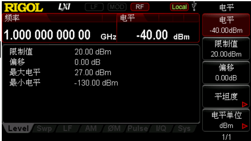
图 9 输出 RF 信号参数设置界面
