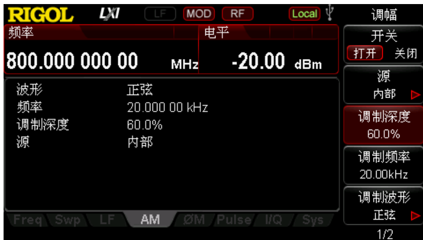
图 11 输出 RF 已调信号参数设置界面
