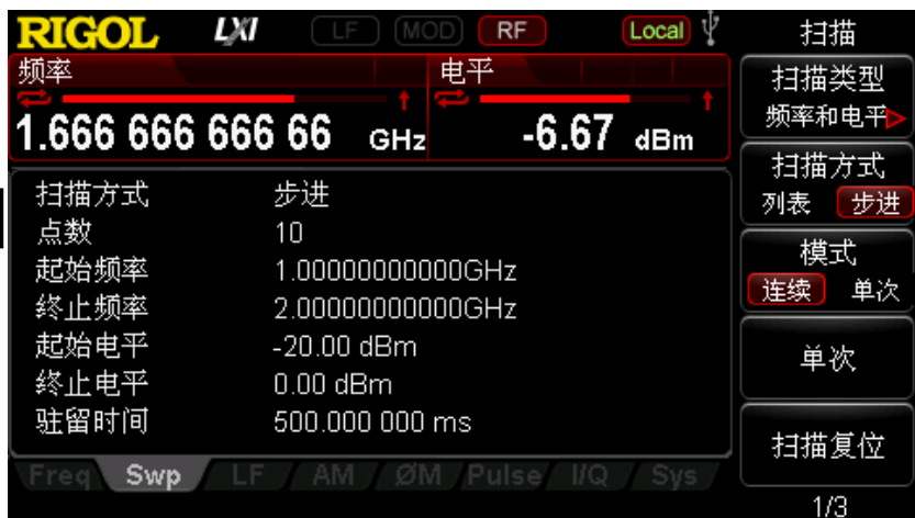
图 10 输出 RF 扫描信号参数设置界面
