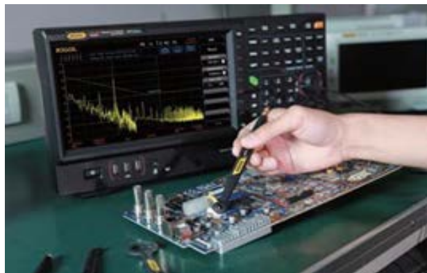
图3. 辐射干扰测试RIGOL方案测试图
