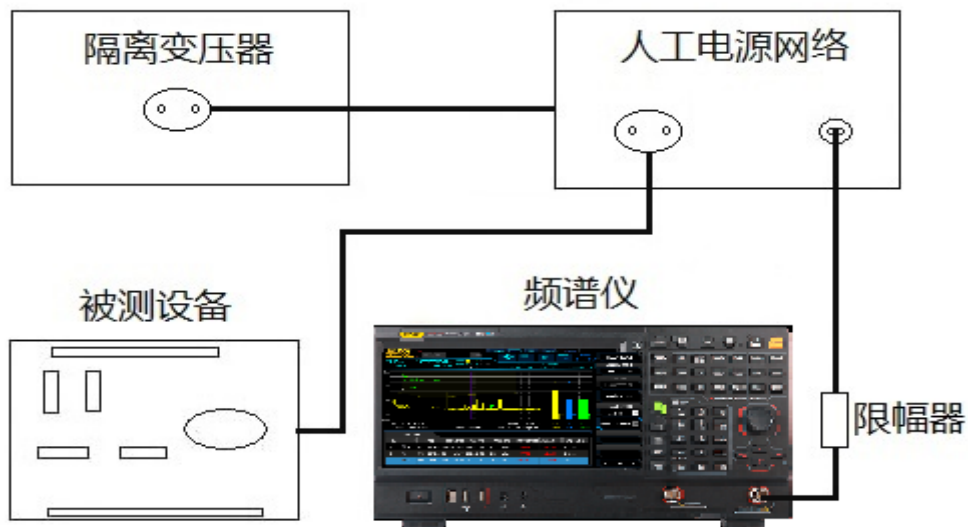
图2b. 传导干扰测试RIGOL方案连接示意图
